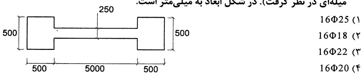
۵۲- ممان اینرسی موثر مقطع یک تیر بتن آرمه با تکیه‌گاه‌های ساده، به ازای بارهای مرده گستردۀ یکنواخت، ۲۰ درصد بیش از ممان اینرسی مقطع ترک‌خورده آن با در نظر گرفتن اثر آرماتور بوده و تغییرشکل آنی در وسط دهانه ۸ mm است. تغییرشکل آنی ناشی از اعمال بار زنده گستردۀ یکنواخت، که از نظر عددی مقدار شدت آن نصف بار مرده است، به کدام‌یک از گزینه‌های زیر نزدیک‌تر است؟
