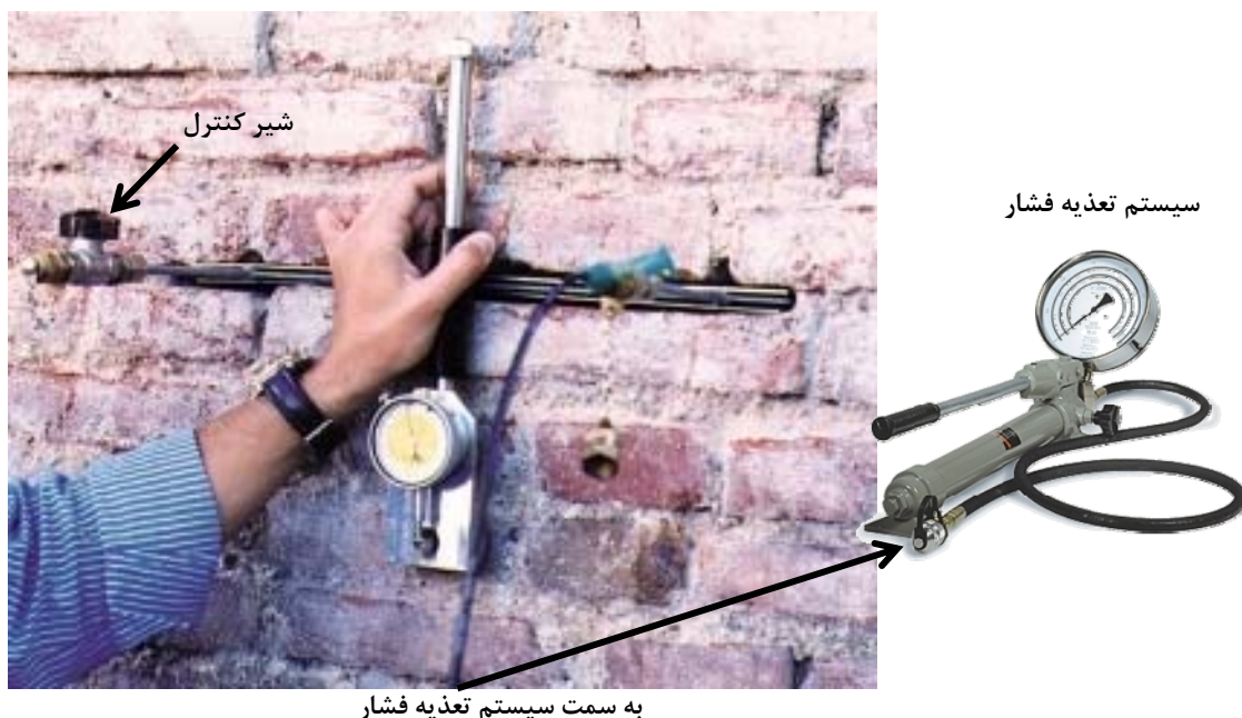
شکل ۲-۳- نحوه انجام آزمایش درجا برای تعیین مقاومت فشاری منشور آجری
