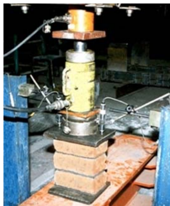
شکل ۲-۲- نحوه انجام آزمایش منشور آجری در آزمایشگاه
